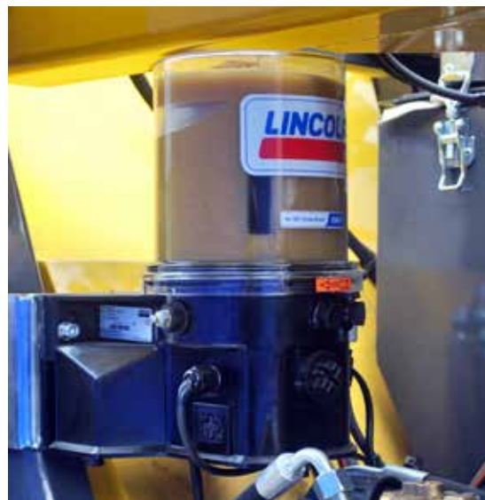
Centralsmörjning underlättar för användaren och förlänger livstiden på maskinen. Finns som tillbehör.
