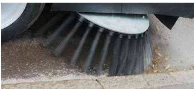
Nordic levereras som standard med vår unika Saja-borste. Med Saja behöver du inte åka till verkstaden utan kan enkelt byta borste själv ute på fältet. Den finns med flera olika material och blandningar.
