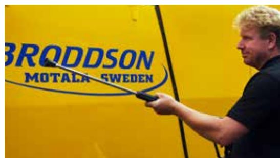
Som tillbehör kan Nordic utrustas med integrerad högtryckstvätt. Mycket användbart ute i fält då utsatta delar som blir rengjorda ger ett bättre resultat.
