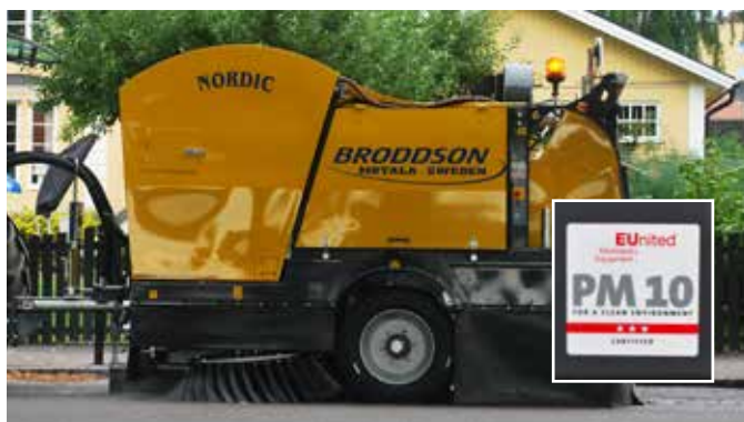
Nordic kan även utrustas med suganordning för findamm, PM10. Det gör maskinen godkänd enligt EU:s miljödirektiv.
