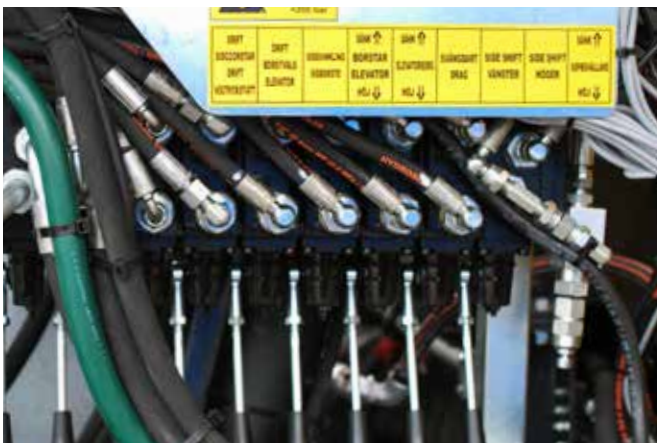
Hydraulblock och andra känsliga detaljer sitter väl skyddade, men samtidigt lättåtkomligt om något behöver justeras.
