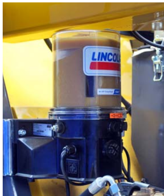
Centralsmörjning underlättar för användaren och förlänger livstiden på maskinen. Finns som tillbehör.
