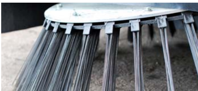
Scandia levereras som standard med vår unika Saja-borste. Med Saja behöver du inte åka till verkstaden utan kan enkelt byta borste själv ute på fältet. Den finns med flera olika material och blandningar.
