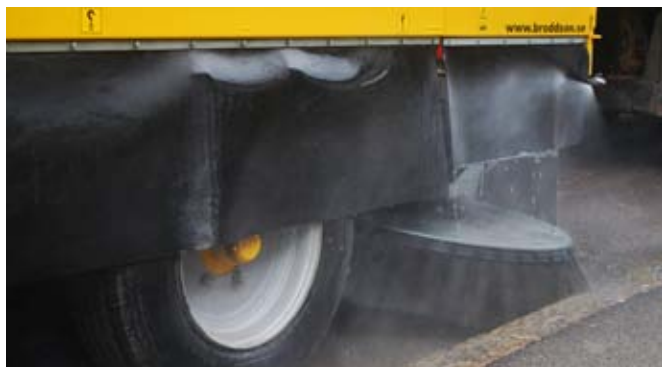
Borstbredden på hela 3000 mm gör att Scandia sopar stora ytor snabbt och ger chauffören bra kontroll på sopningen då arbetet kan följas i backspeglarna.
